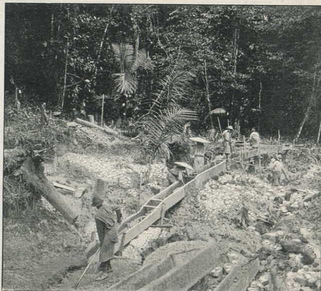
DANS LES PLACERS. — Les mineurs extraient l'or en employant le vieux procédé des caniveaux
