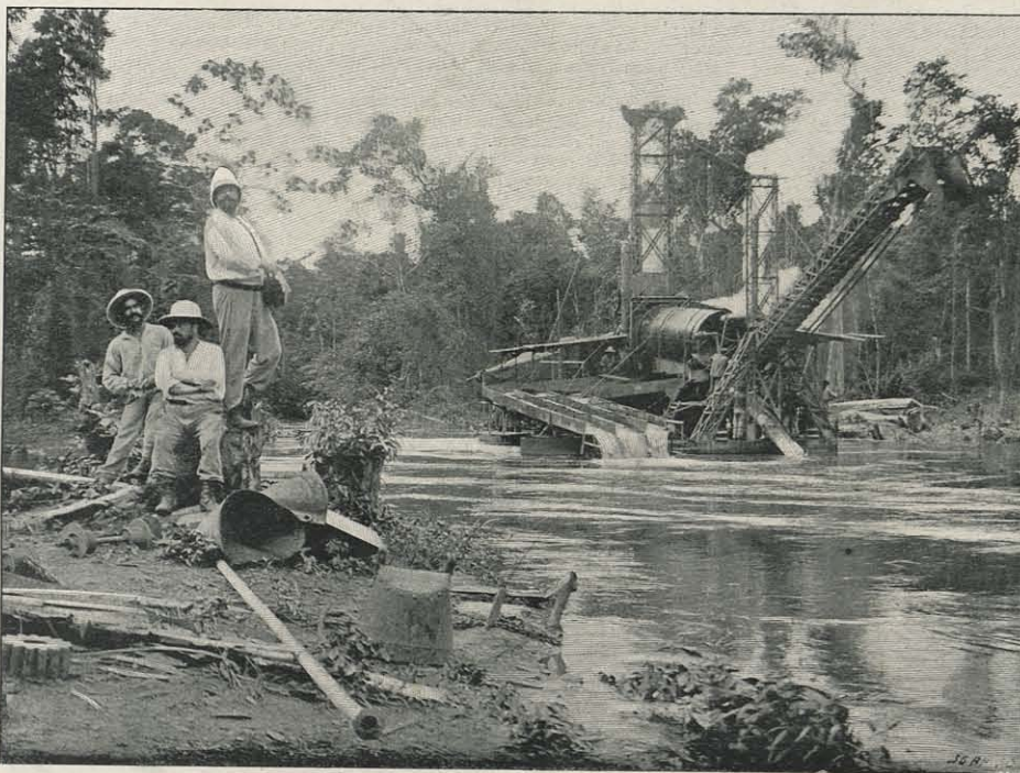
CENTRE AURIFÈRE DE SPORWIN. — De puissantes dragues ont été montées pour opérer le lavage rapide des terres renfermant des pépites d'or
