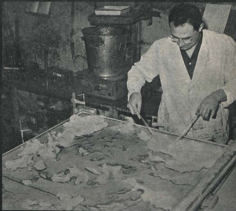
Le maître verrier Guy Soleille dispose la ouate de verre sur laquelle il versera le polyester.
