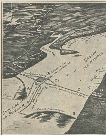
FIG. 7. — BARRAGE PROJETÉ DE LA SEVERN
