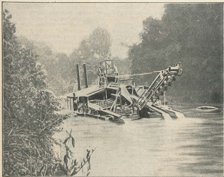
DRAGUE WERF CONRAD DRAGUANT LE FOND D'UNE RIVIÈRE AURIFÈRE
