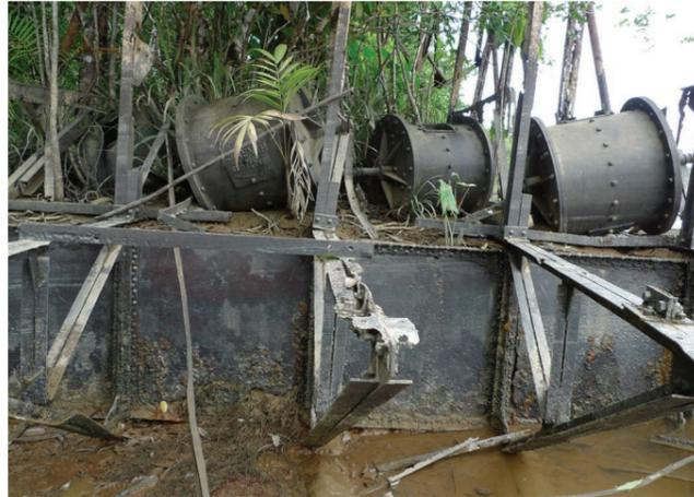
Broyeurs à boulets, foreuse flottante de la montagne Baugé
