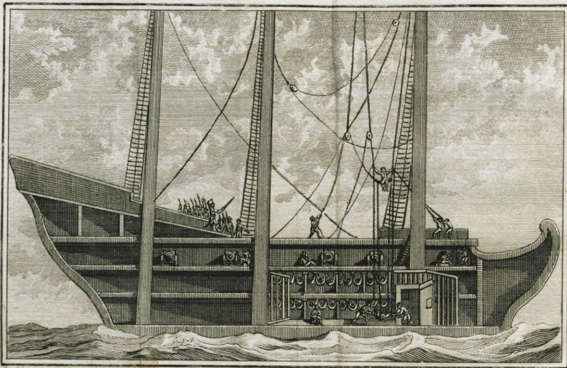
L'entrepont à 30 p.<sup>ds</sup> de large: 37 de long: 4  $\frac{1}{2}$  de haut: 193 personnes y sont logées avec leur sac de nuit. Deux rangs de hamacs les uns sur les autres sont soutenus de 3 p.<sup>ds</sup> en 3 p.<sup>ds</sup> par de petites colonnes (ou Epontilles) le tout est fermé par de grosses barres de bois, et par deux grosses portes de prison avec leurs verrous. Le jour ne pénètre qu'à regret dans ce Manoir (Voyage à Cayenne Tome 1.<sup>er</sup> page 65 et suivants)
