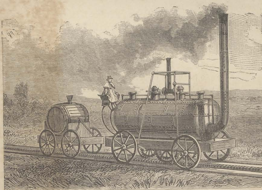
FIG. 44. — LA LOCOMOTIVE DE BLENKINSOP, A CRÉMAILLÈRE CENTRALE
