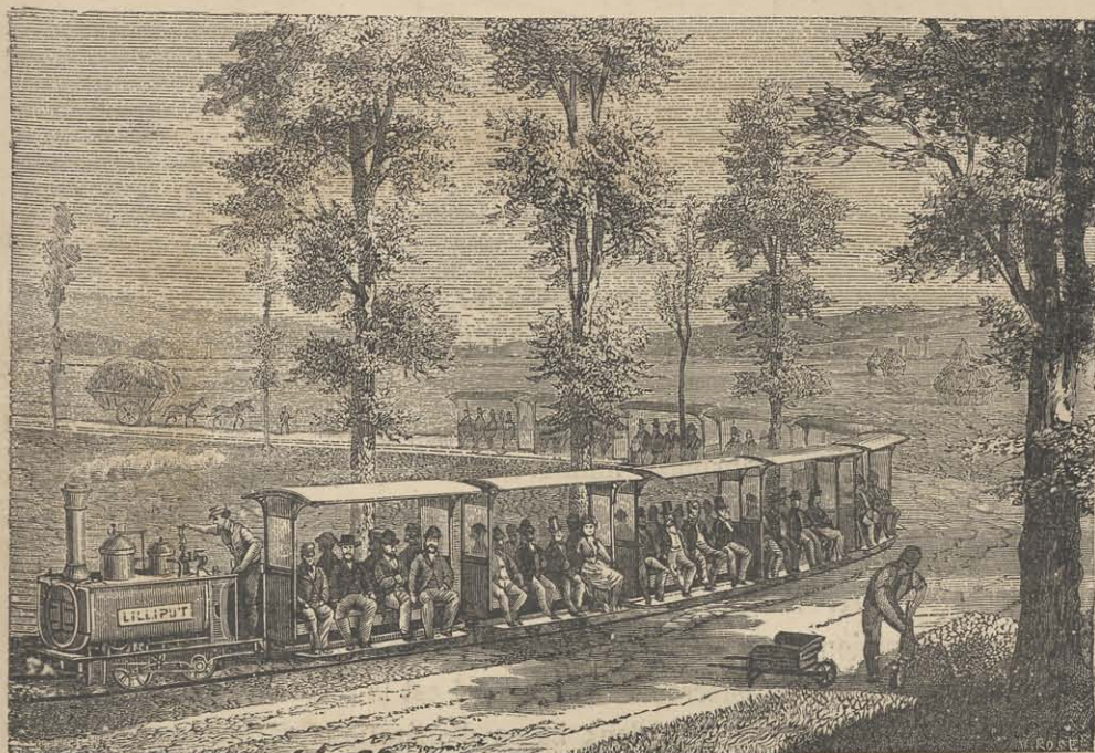
FIG. 138. — APPLICATION DU PORTEUR DECAUVILLE (VOIE DE 0 m ,50) AU TRANSPORT DES VOYAGEURS AU JARDIN D'ACCLIMATATION DU BOIS DE BOULOGNE, A PARIS
