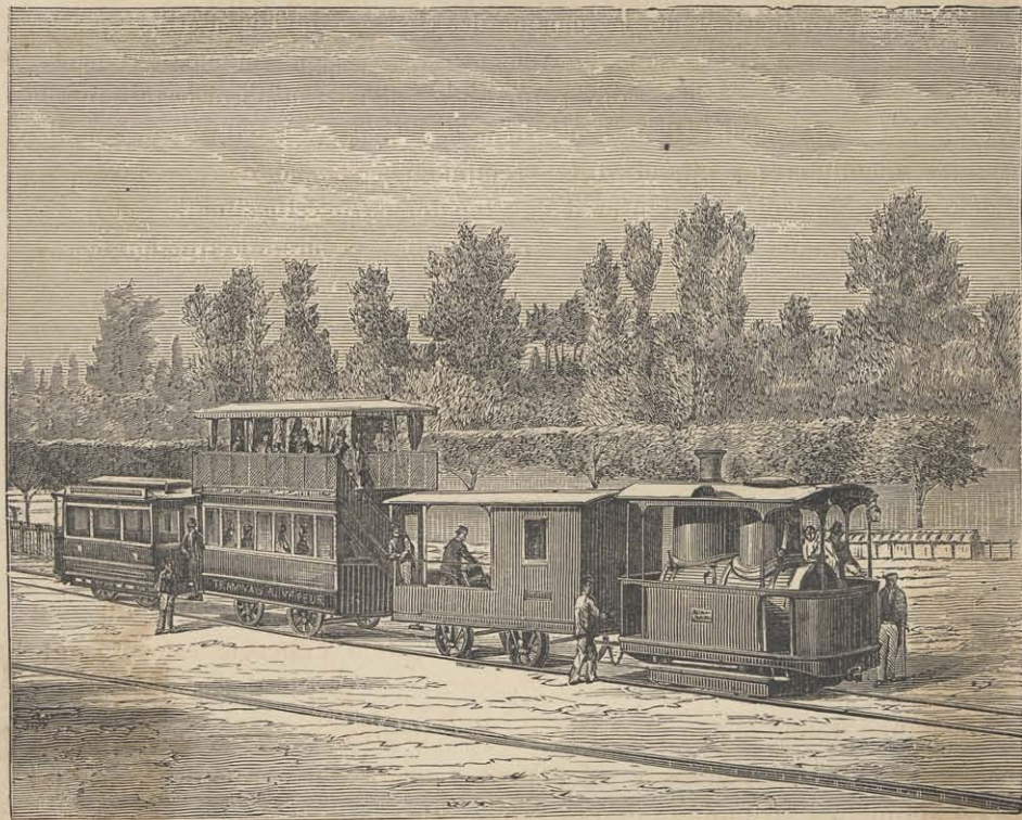
FIG. 96. — LE TRAMWAY DE RUEIL A MARLY MENÉ PAR LA LOCOMOTIVE A EAU CHAUDE
