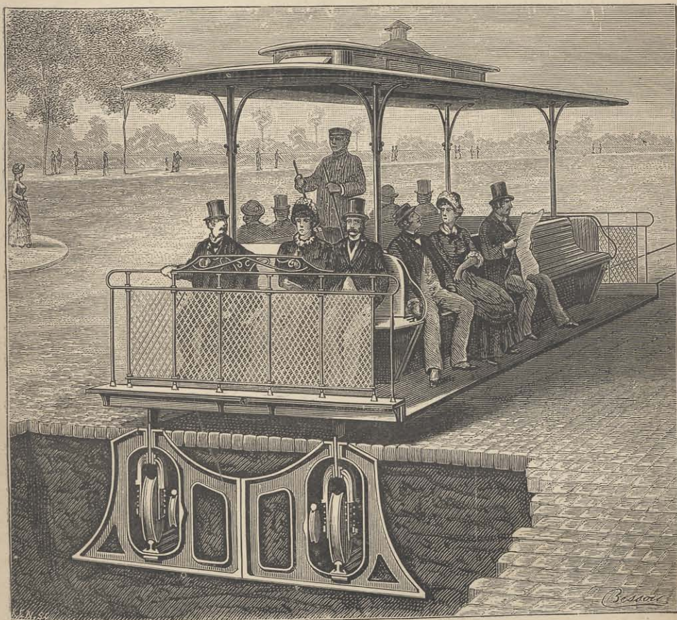
FIG. 102. — TRAMWAY FUNICULAIRE DE SAN FRANCISCO, A ROUES INVISIBLES
