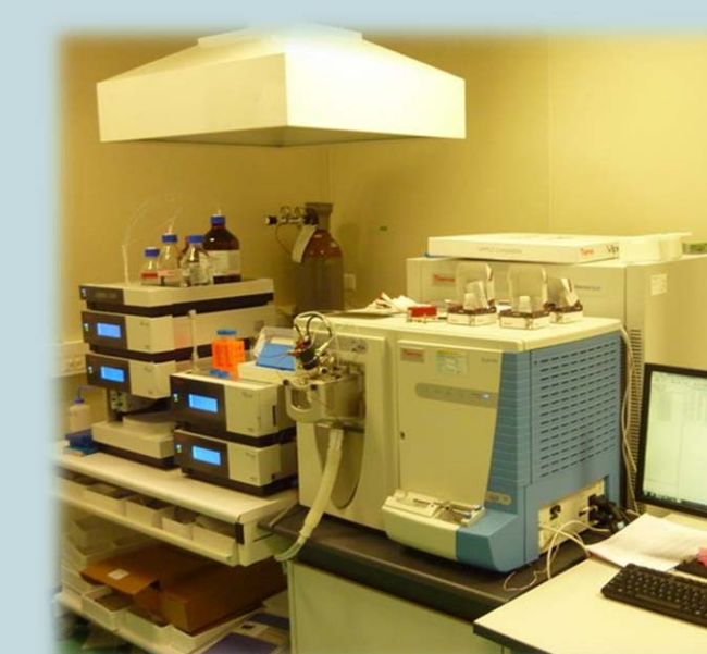
Figure : Spectromètre de masse (Orbitrap Elite, Thermo Fischer) couplé à une chaîne HPLC (Dionnex Ultimate 3000)
